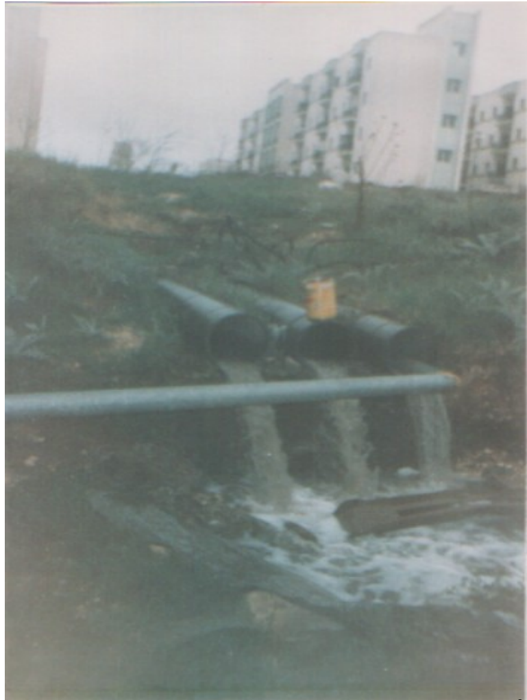
شكل (4): صورة أنابيب التصريف لنقطة القياس الهيدرومترية مع وعاء (4 لتر) لقياس التصريف الصغيرة.
