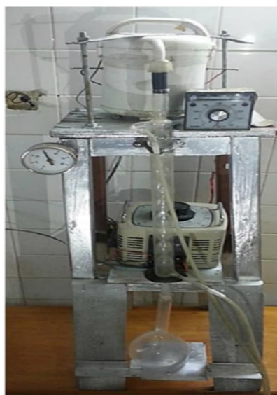
شكل: (5). جهاز استخلاص زيت القرنفل بالتسخين الاومي (Al-Hilphy, 2014).
